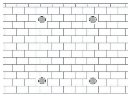
Forare la parete in corrispondenza dei fori delle piastrine ad "L". Utilizzare le viti e i tasselli in dotazione per fissare l'amplificatore al muro.
