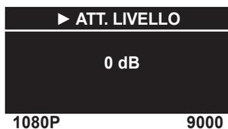
Consente di impostare l'attenuazione del livello del segnale in uscita da 0 a 15 dB.
