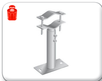
Zanca tubolare telescopica Palo Ø 40÷70 mm (07-623/A) Palo Ø 40÷90 mm (altri art.) Piastra 200x70x4 mm
